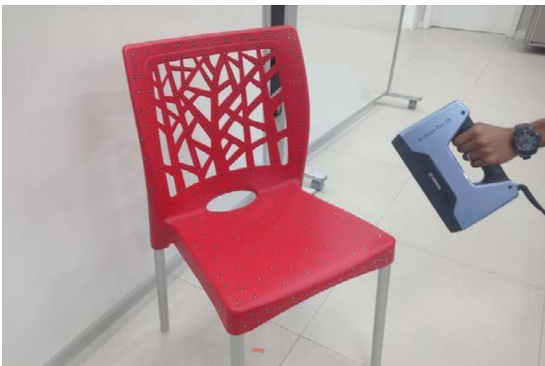
Figura 3 – Escaneamento da cadeira com o Einscan Pro 2x. Fonte: De autoria própria.
