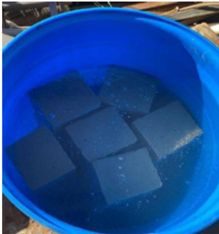
**Figura 16.** Cura dos Corpos de provas submersos.
