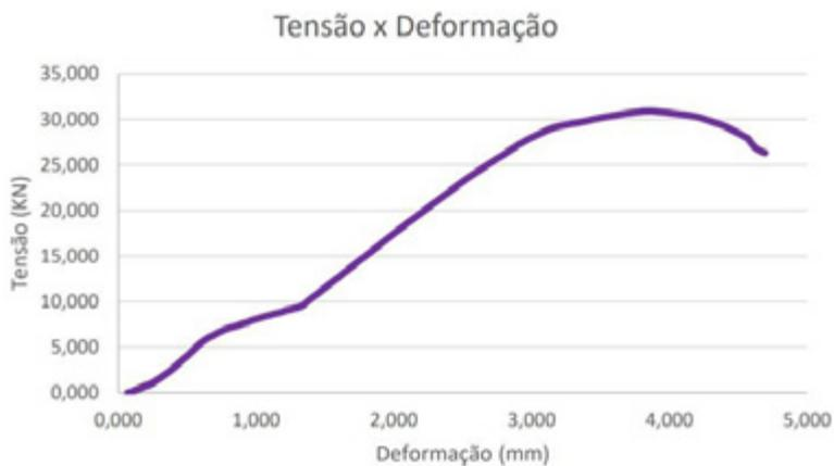
**Gráfico 5.** Corpo de prova com armadura de GFRP 02
