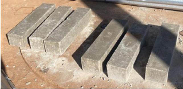
**Figura 7.** Corpo de prova em concreto armado.
