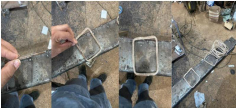
**Figura 13.** Execução dos Estribos em GFRP.
